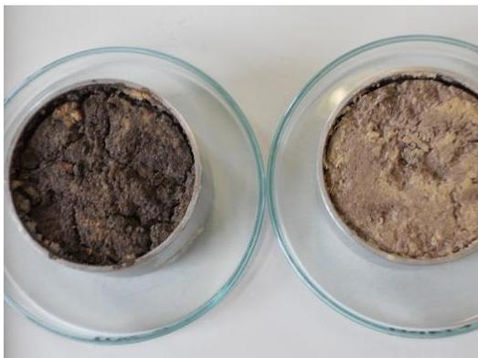
Abb. 7 Stechzylinder nach dem Trocknen auf Massekonstanz - erkennbare Fehlstellen vor allem an den Rändern. Foto: Messenböck K.
