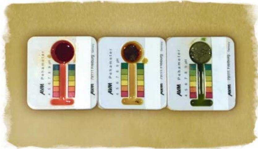
**Feld-Methode:** Boden wird mit Indikatorflüssigkeit (KCl plus Farbindikatoren) überstaut. Das Kalium (K) mobilisiert austauschbare Säure im Boden, welche zur Farbreaktion führt.
