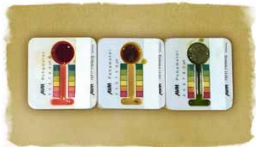
**Método de campo:** La muestra de suelo se inunda con líquido indicador (KCl más indicadores de color). El potasio (K) moviliza el ácido intercambiable en el suelo, lo que provoca la reacción de color.
