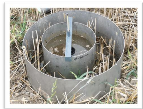
Doppelring-Infiltrationsmeter mit eingesetztem Schwimmer
