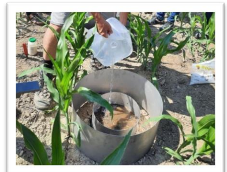
Messung der Infiltration mit PVC-Rohr (Symbolbild oben) oder Doppelring-Infiltrrometer (unten)
