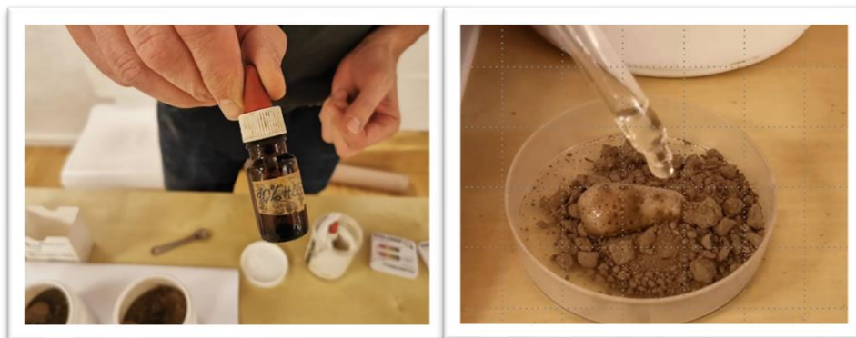
10%-ige Salzsäure (links) und aufschäumende Reaktion bei Vorhandensein von Karbonaten (rechts)
