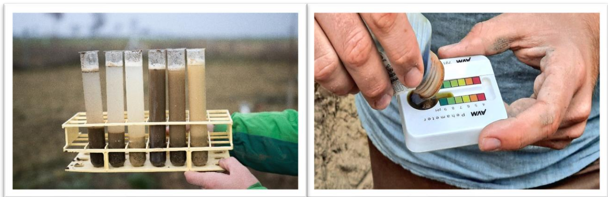
Bestimmung der Aggregatstabilität (links) und des pH-Werts im Neutralsalz (rechts)
