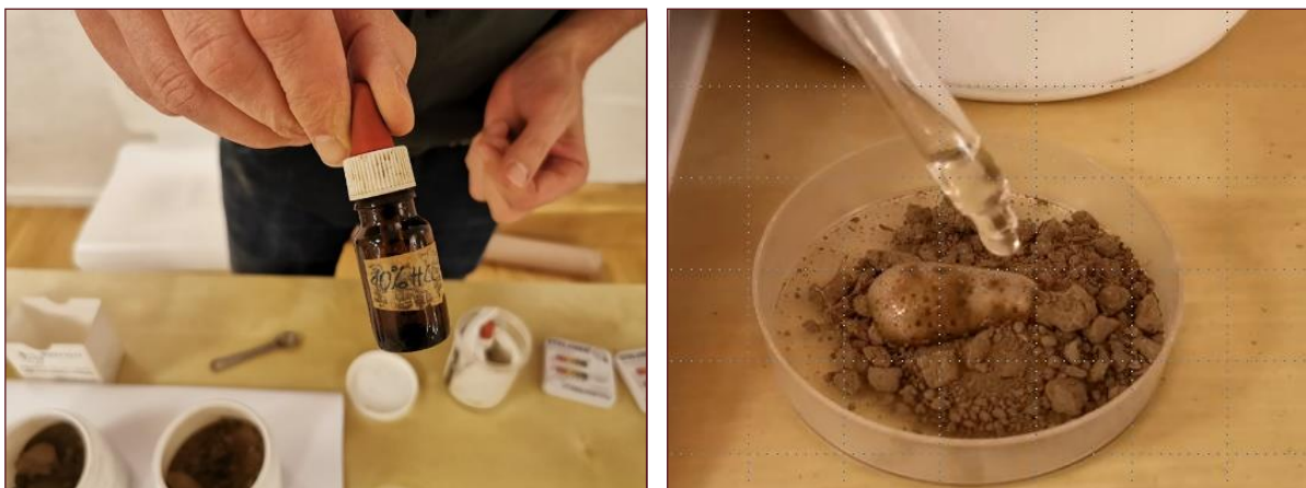
Wenn Boden bei Beträufeln mit 10%-iger Salzsäure reagiert, ist im Boden Carbonat enthalten.
