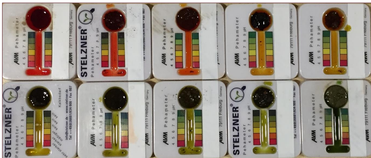
Beispiele von Farbreaktionen zur Bestimmung des pH-Werts im Neutralsalz (rot = stark sauer, orange = schwach sauer, gelb/braun = neutral, grün = alkalisch)
