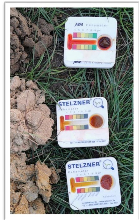
pH-Messungen (Neutralsalz) in verschiedenen Tiefenstufen
