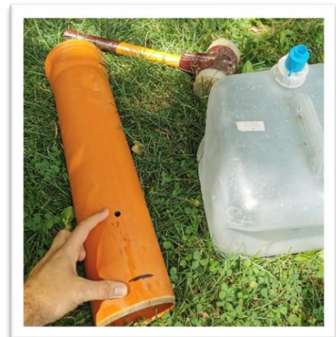
PVC-Rohr mit markierter Einschlagtiefe und Füllhöhe (10cm)
