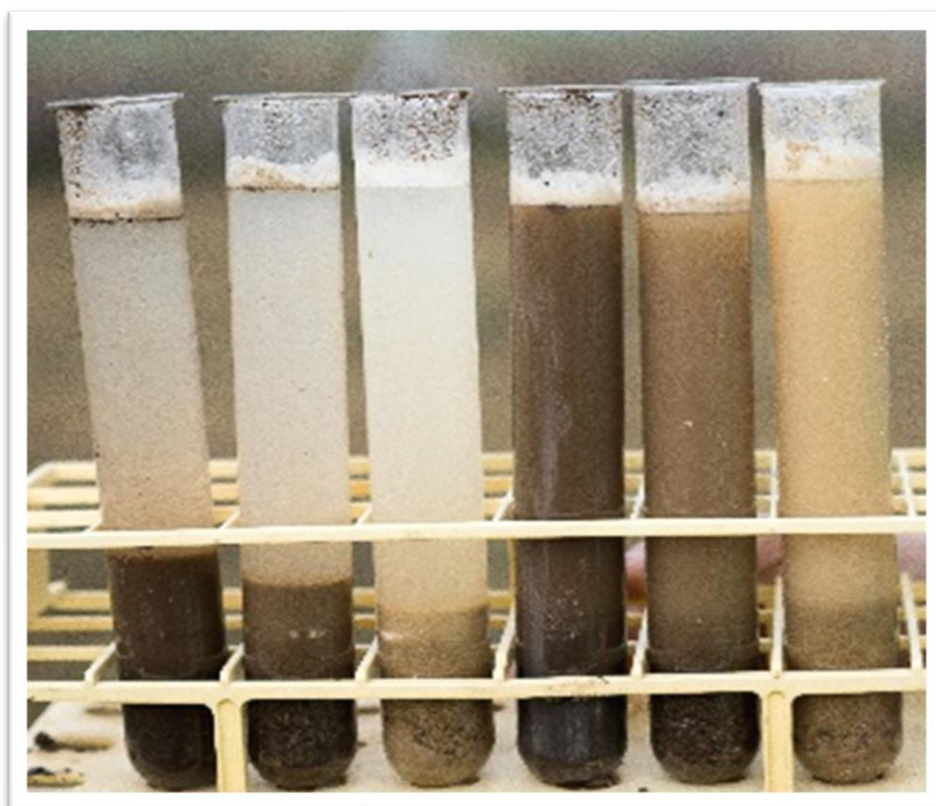
Vergleich der Trübung der überstehenden Flüssigkeit verschiedener Bodenproben zur Beurteilung der Aggregatstabilität
