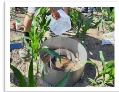
Messung der Infiltration mit PVC-Rohr (oben) oder Doppelring-Infiltrometer (unten)
