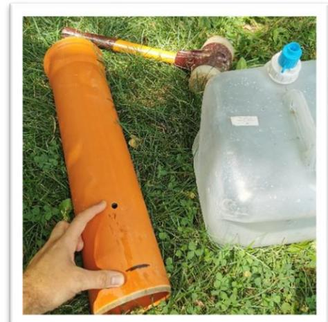
PVC-Rohr mit markierter Einschlagtiefe und Füllhöhe (10cm)
