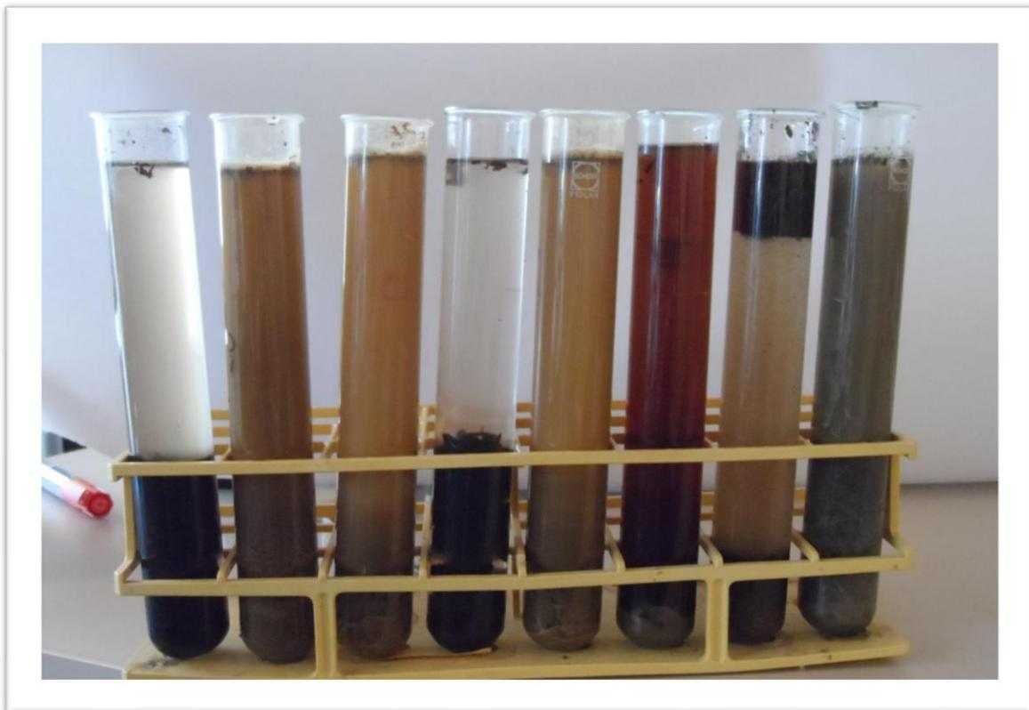
Vergleich der Trübung der überstehenden Flüssigkeit verschiedener Bodenproben zur Beurteilung der Aggregatstabilität
