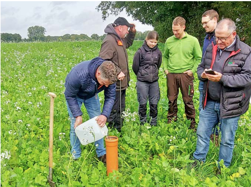
Ein Kunststoffrohr wurde 3 Zentimeter tief in den Boden eingeschlagen für einen Versickerungsversuch. Anschließend schüttete ein Seminarteilnehmer Wasser in das Rohr. Mit der Wassermenge wurde ein Niederschlag von 100 Liter pro Quadratmeter simuliert.
