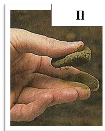
Test rozcierania określający zawartość piasku, pyłu i iłu
