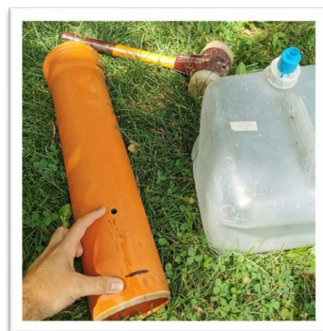
Rura PVC z zaznaczoną głębokością wbicia w glebę i poziomem napełnienia
