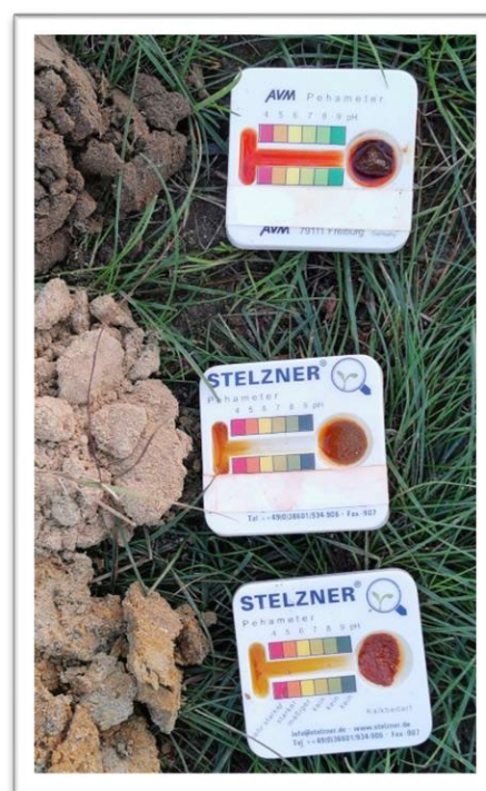
Pomiar pH w soli neutralnej na różnych głębokościach
