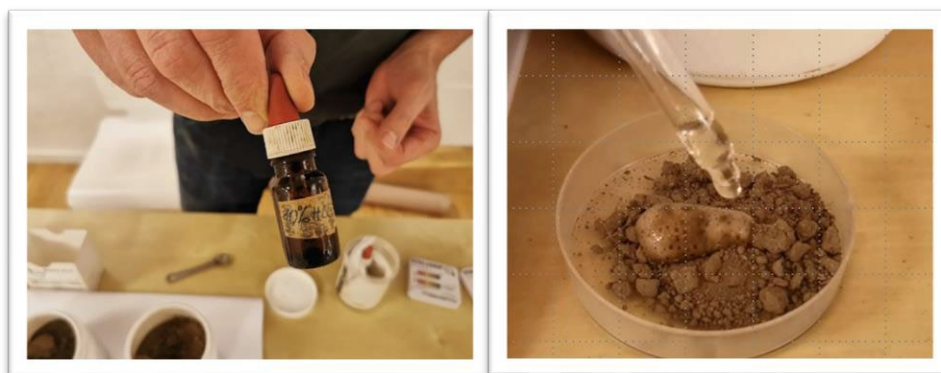
10% kwas solny (z lewej) i reakcja pienienia wskazująca na obecność węglanów w glebie (z prawej)
