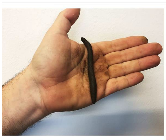
Austriacki trójkąt tekstury gleby ÖNORM L 1050 (z lewej) i "wałeczek" uformowany z gleby (z prawej)
