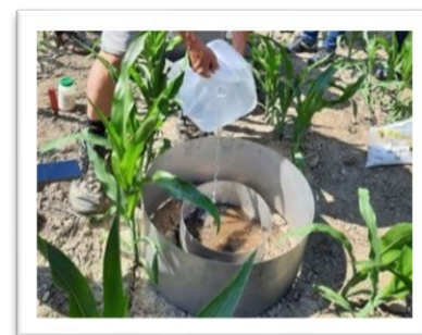
Pomiar infiltracji z pomocą rury PVC (u góry) lub z pomocą infiltrometru dwupierscieniowego (na dole)
