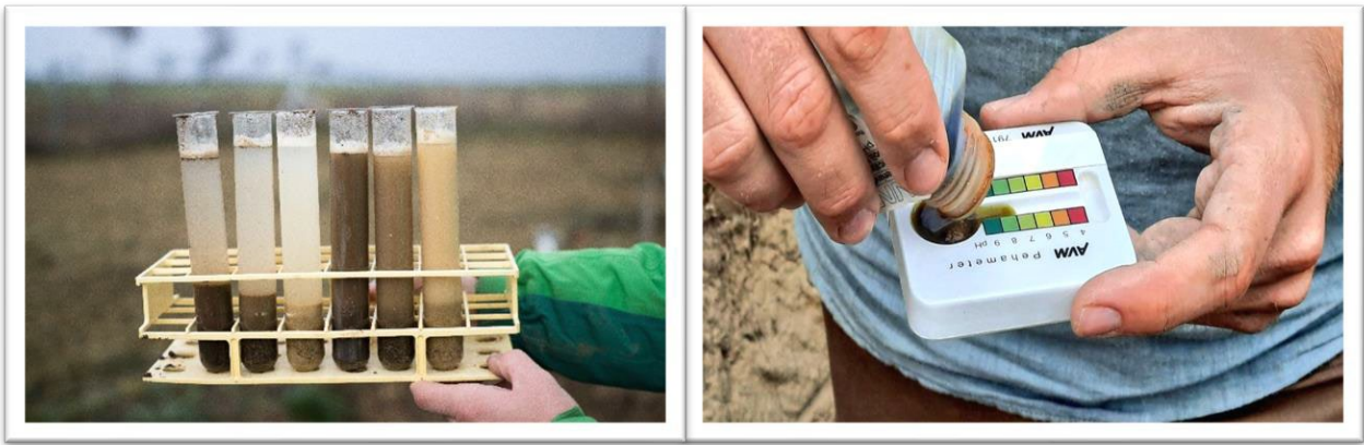
Ocena stabilności agregatów glebowych (z lewej) i pomiar pH w soli obojętnej (z prawej)
